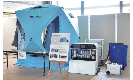
▲ポータブル水再生プラント[WOTA BOX]と仮設シャワー
