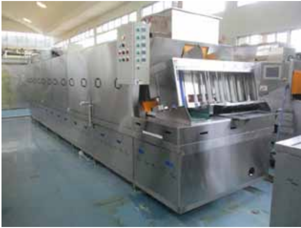
写真：システム食器類洗浄機
