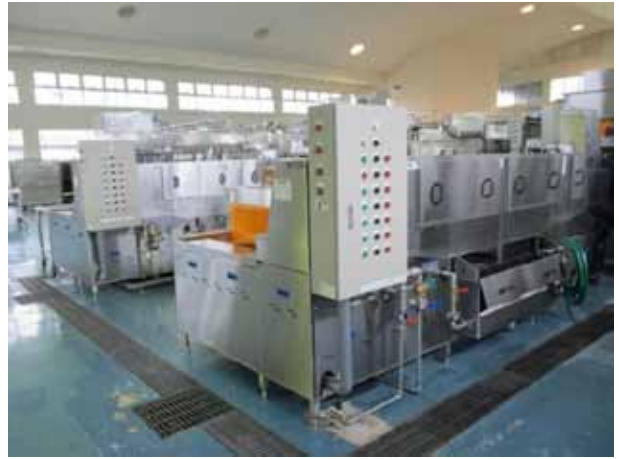
写真：スプーン洗浄機付き浸漬装置
