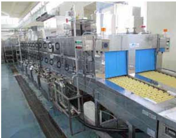
写真：システム食缶洗浄機
