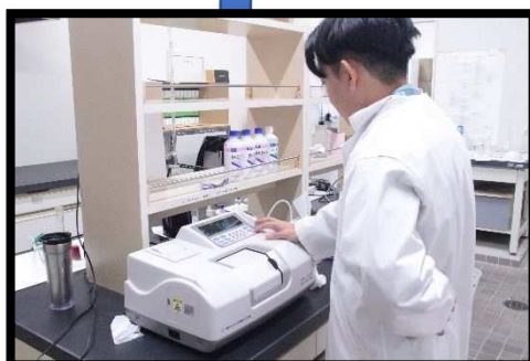
▲機器を使った色度・濁度の測定
