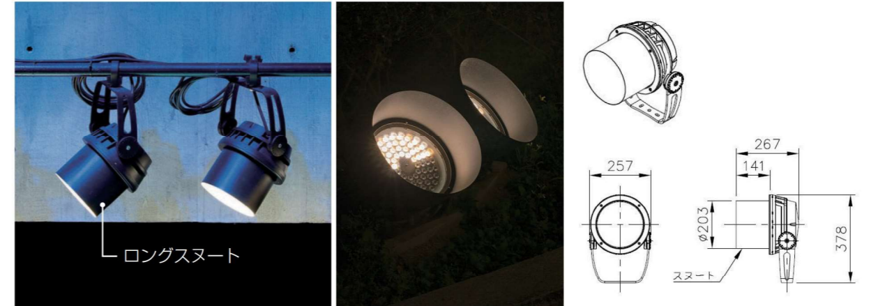
照明器具にはロングスヌートを取り付けることで、照射ポイント以外への光漏れを抑制 鑑賞動線から光源が直接見え難くなるようにグレア対策を図ります
