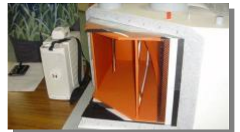
内部は非金属製のタンクが何重にもなっている
